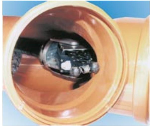
Anschlüsse, Abzweiger usw. können einfach befahren werden.
