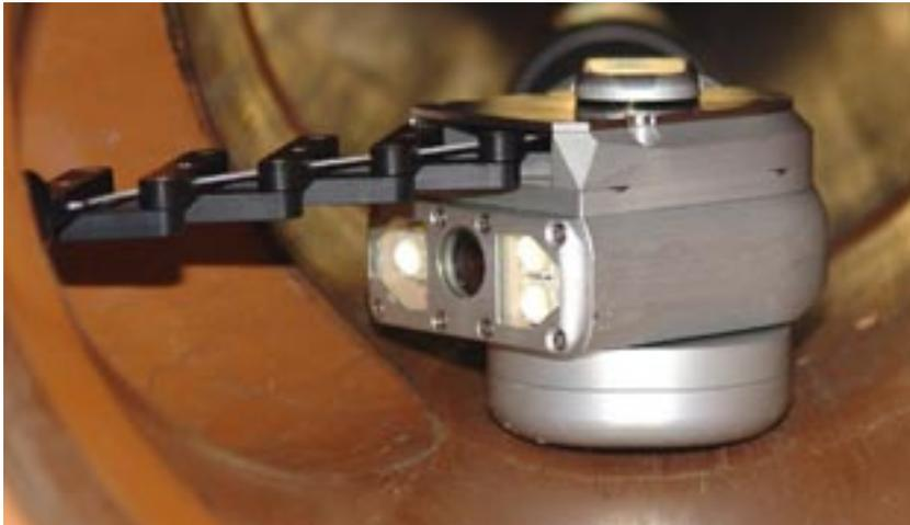
Als Satellitensystem aber auch mit HD-Düsenvorschub. Die ideale Vorrichtung zur Reinigung, Inspektion und der 3-dimensionalen Vermessung von verzweigten Entwässerungsanlagen mit xy, xz, yz-Grafik. Die Lindauer Mini-Schere wurde seit dem erfolgreichen IKT-Warentest nochmals weiterentwickelt.
